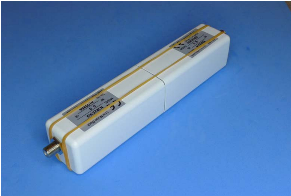
図-4 : 対向させた二台の LNC、片側が ACNS となる
