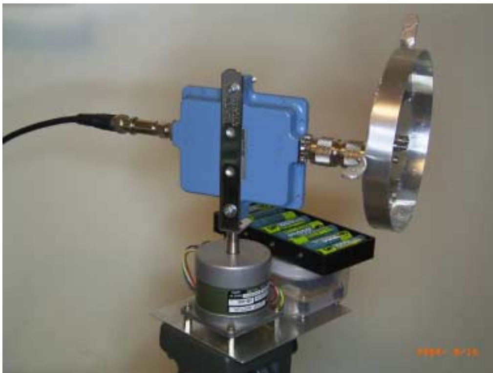
写真-1 : 簡易アンテナ・ポジショナの外觀 … 単なるモータ
