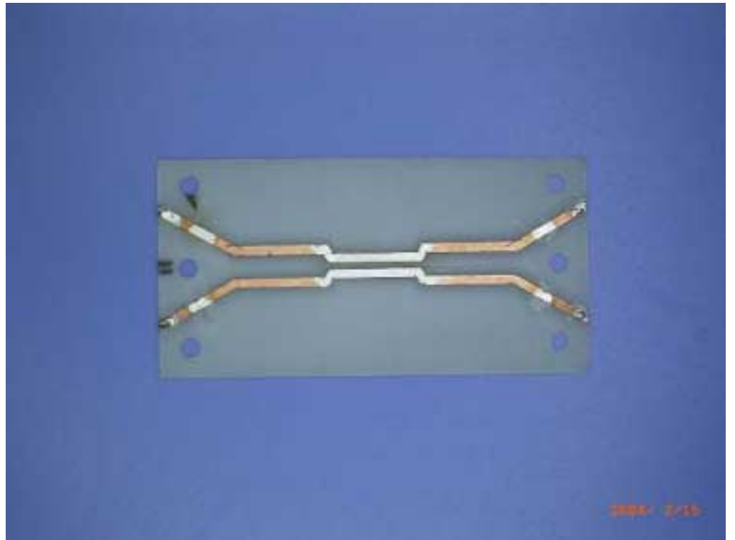
写真-4 : 対称3段型の方向性結合器の内部パターン
