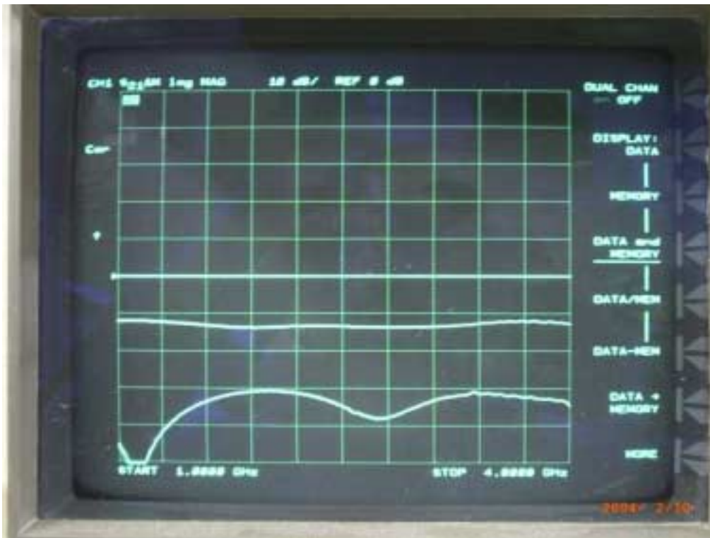
写真-1 : テフロン基板による3段方向性結合器
