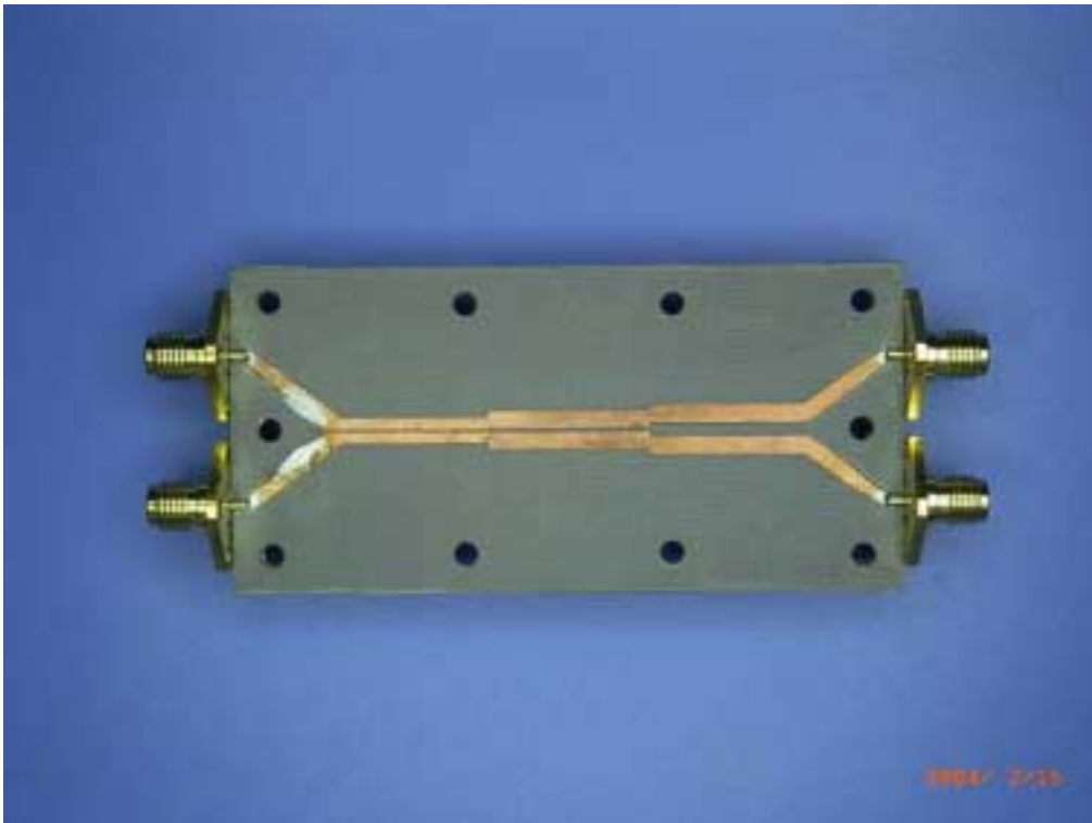
写真-3 : 非対称3段型の方向性結合器の内部パターン
