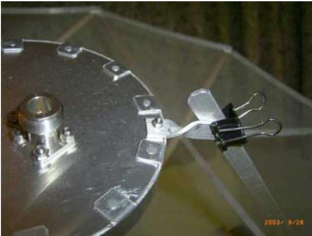
写真-11 : フィードサポート(上部)
