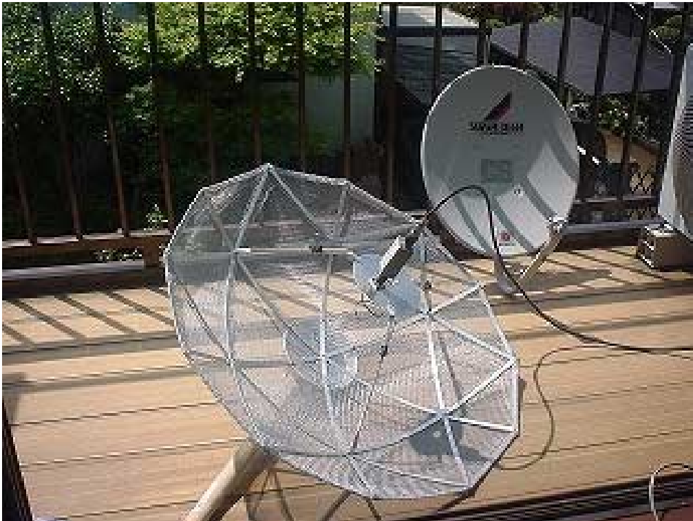
写真-3 : フィードを装着して完成!
