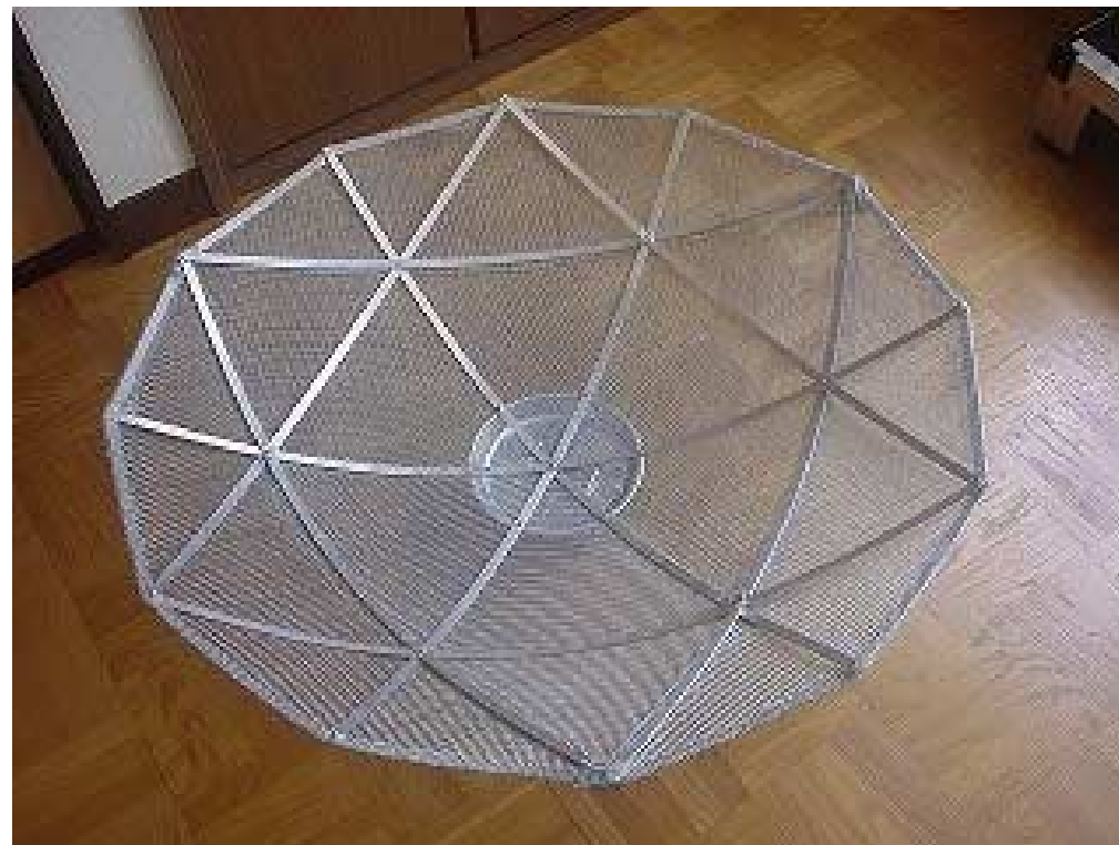
写真-2 : 網張りを完了して、センターハブを装着
