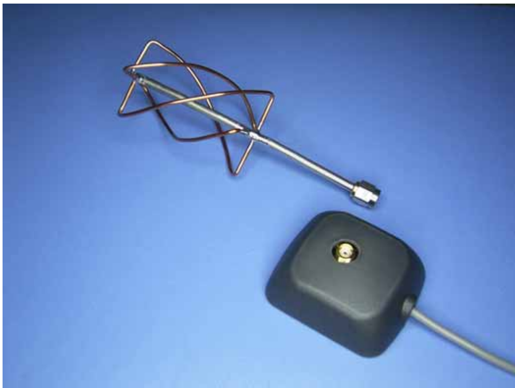
写真-3 : パッチ・アンテナ改造によるアンプ(右下)
