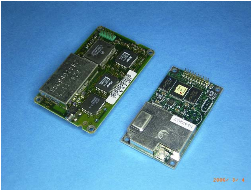
写真-3 : GPS 受信機 — VP Oncore (左)、Jupiter-T(右)
