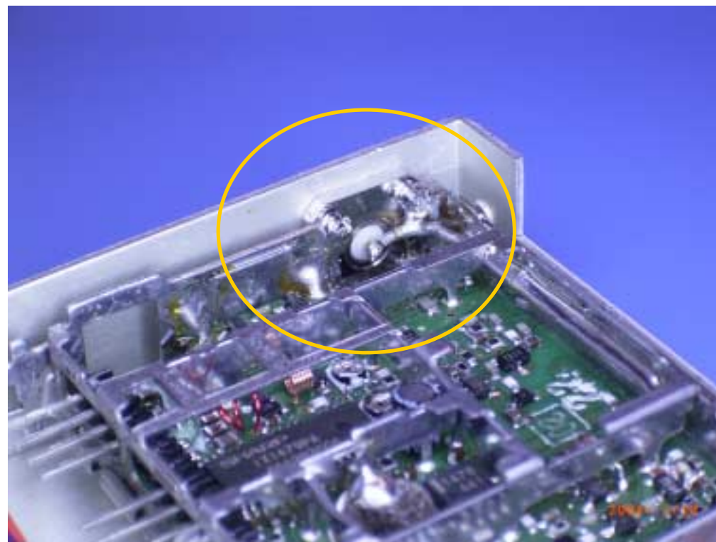
写真-2 : SMA 型コネクタに交換
