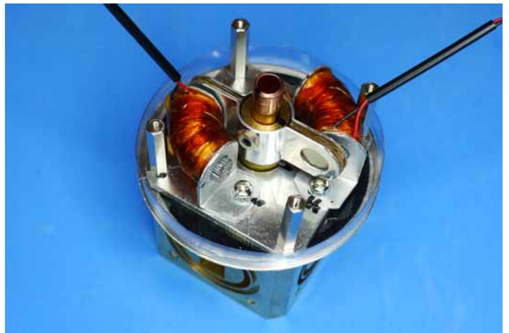
図-5 : 電動導波管切替器 - 「ロータリー型二気筒エンジン」
