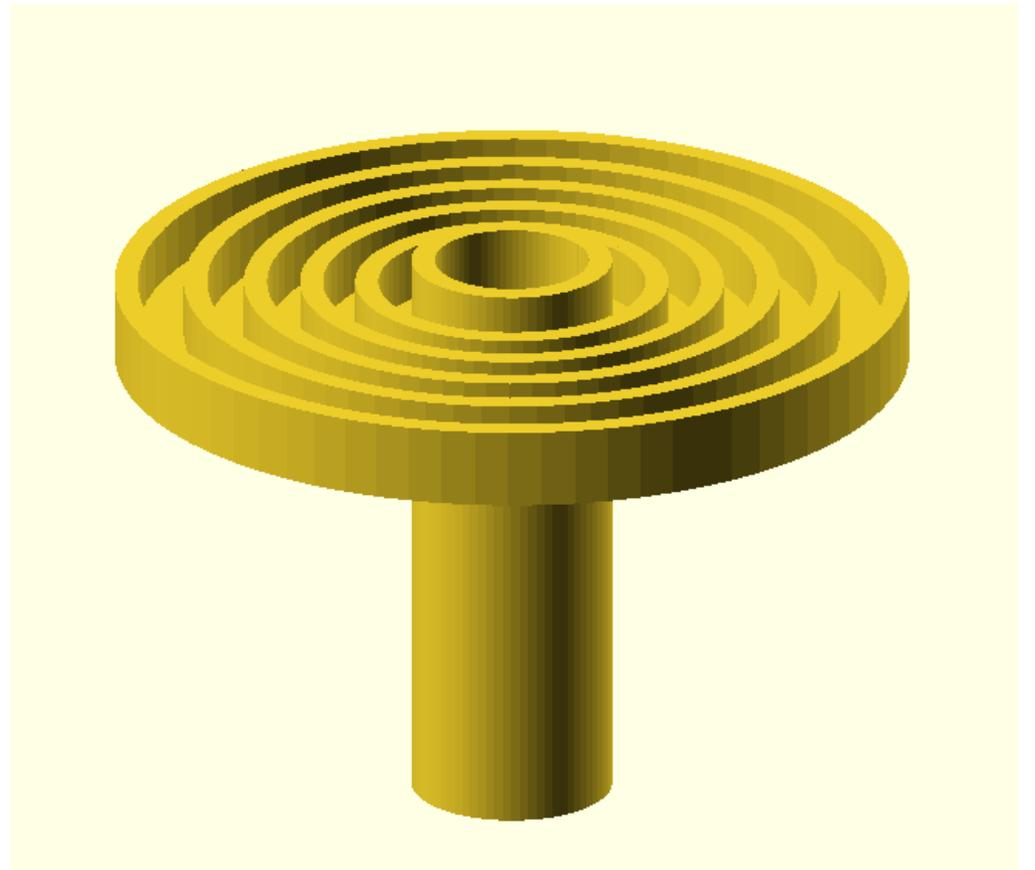
**図-7** : 5 リング・チョーク型ホーン・アンテナ Thick Plate Model ( t = 3 mm )
