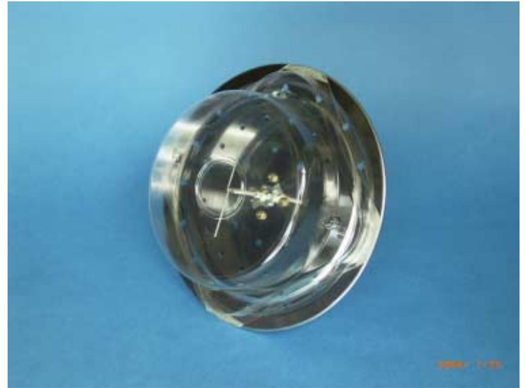
写真-3 : 反射板付きダイポール・アンテナ (基準アンテナ)
