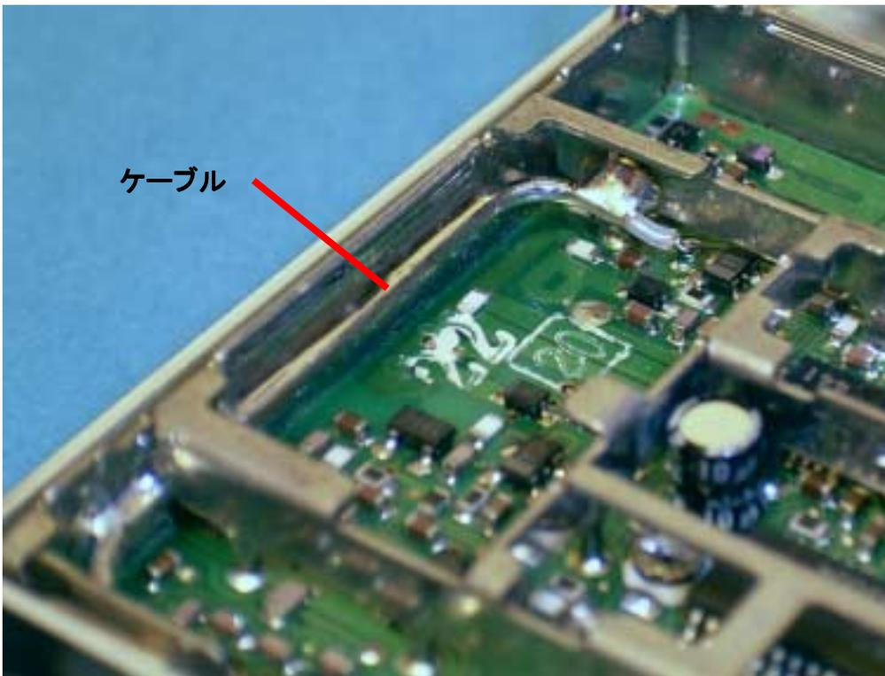
写真-4 : 信号取出しケーブルの引回し
